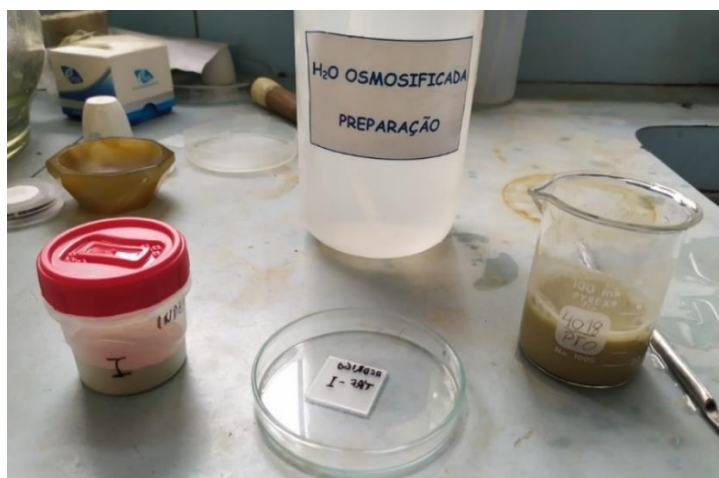
Figura 27: Amostra e material utilizado no método da lâmina de vidro
